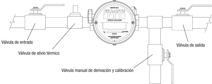
Los medidores de desplazamiento positivo (DP) están diseñados para funcionar llenos de líquido. El medidor se debe instalar en una ubicación, donde permanezca lleno de líquido en todo momento. Se puede instalar en tuberías verticales, debido a que el líquido fluye hacia arriba.
