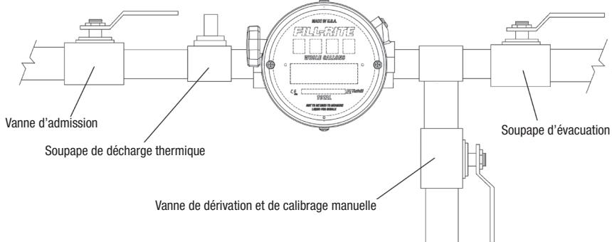
Les compteurs à déplacement positif sont conçus pour fonctionner avec le plein de liquide. Le compteur doit être installé dans un emplacement toujours plein de liquide. Il peut être installé dans les lignes verticales à condition que le liquide s'écoule vers le haut.
