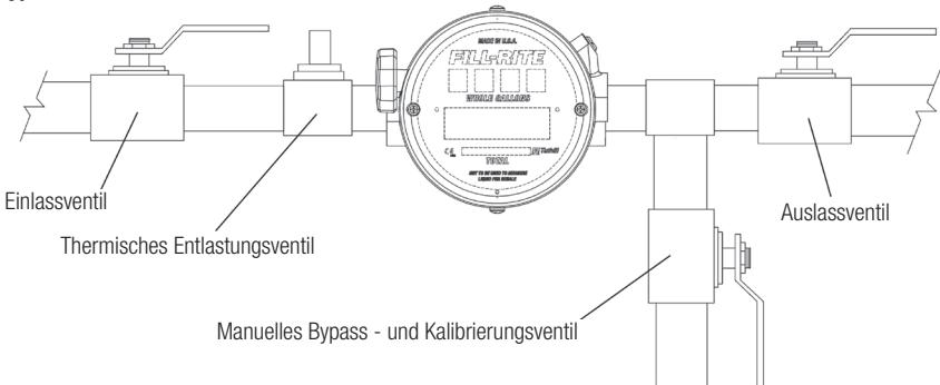
Direktverdrängungs-Zähler (PD) sind zum Betrieb mit Flüssigkeitskomplettfüllung vorgesehenen. Der Zähler muss an einer Stelle eingebaut werden, an der er immer mit **Flüssigkeit gefüllt** ist. Er kann in senkrechte Leitungen eingebaut werden, solange die Strömung nach oben gerichtet ist.
